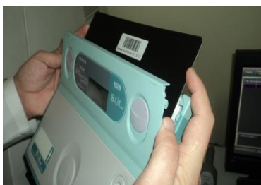
Fig 5. Placa de Fósforo introduzida no cassete
